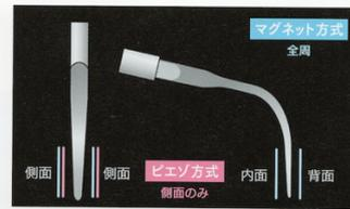
側面、背面、内面で構成される。マグネット方式では金属を使用することができるが、ピエゾ方式では基本的に使用するの側面のみとなる。
