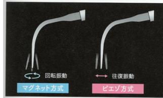
マグネット方式はチップの先端が楕円回転運動をするのに対して、ピエゾ方式は往復振動。ただし、ピエゾ方式でも太いチップでパワーを強にすれば回転振動となる。
