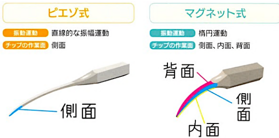
図2-2 マグネット方式とピエゾ方式の振動様式の違い
